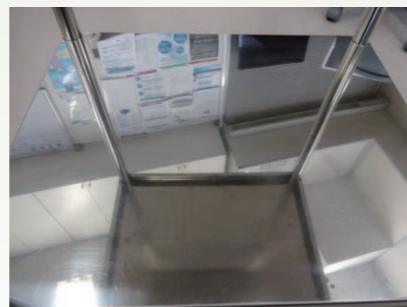
【トレシーで仕上げ拭きをした写真】 拭き取り痕(残渣)が見られない
